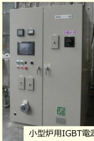
小型炉用IGBT電源装置
