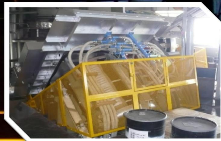
炉体傾動式転落防止安全柵
