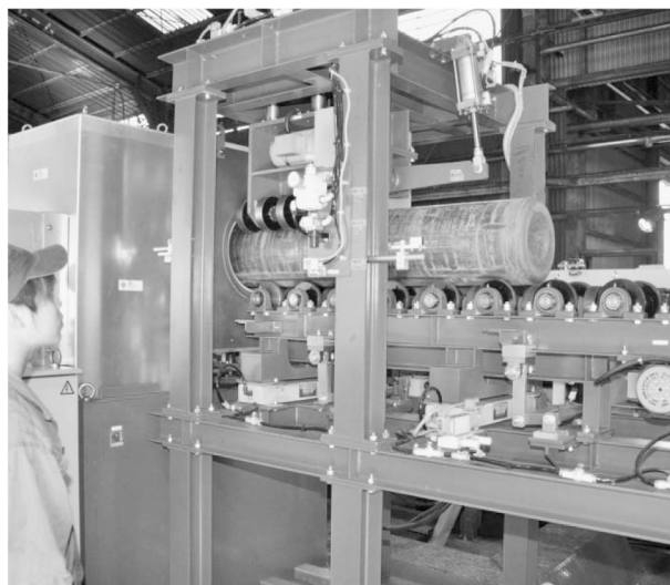
シームレス容器の原管を誘導加熱装置の中に入れて加工
